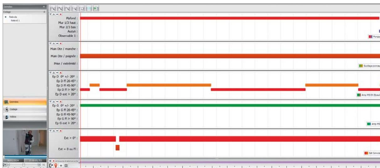
▲ Chantier 1 – Relevé des postures sur une phase de ponçage en plafond avec ponceuse de type girafe à dépression sans exosquelette
