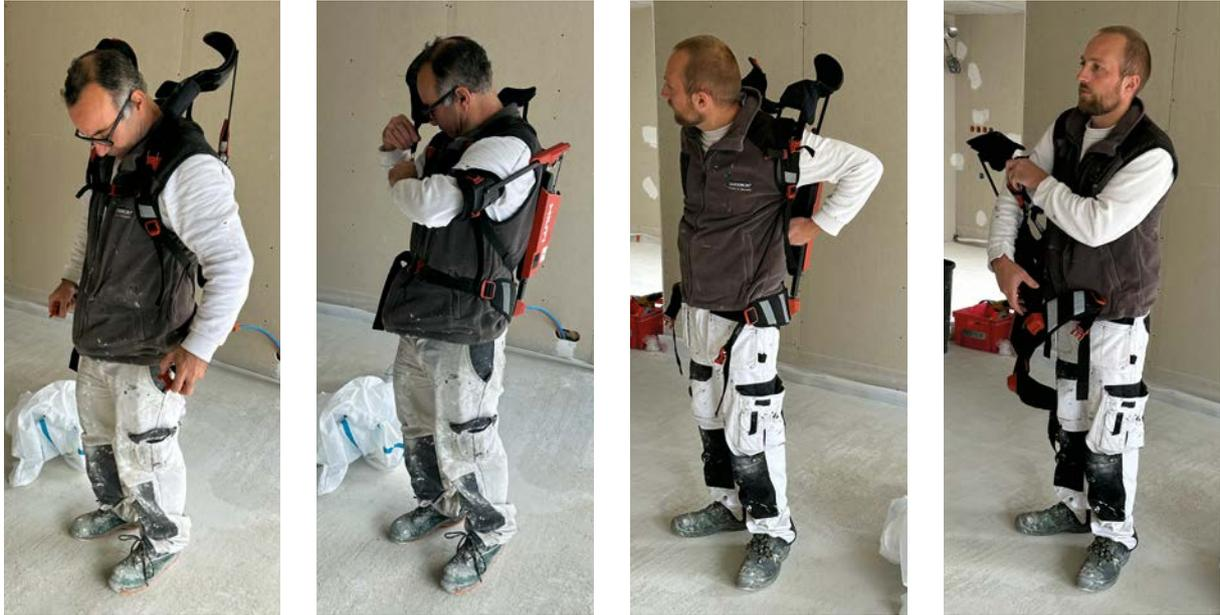
▲ Chantier 1 – Installation et désinstallation de l'exosquelette d'assistance « bras en hauteur » et soutien cervical
