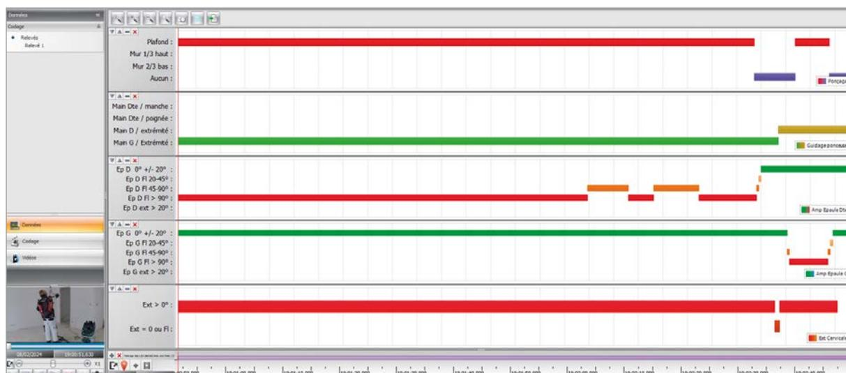
▲ Chantier 1 – Relevé des postures sur une phase de ponçage en plafond, avec ponceuse de type girafe à dépression et exosquelette
